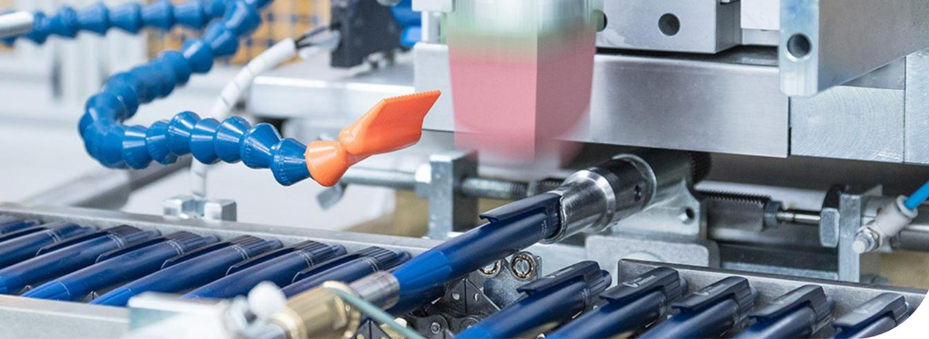
Klein- und Großserien werden mithilfe von Tampon- oder Siebdruckverfahren individualisiert.
