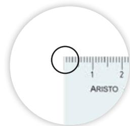
Skalen entsprechen der Ö-Norm A-2131. 0-Punkt an der Kante des 90° Winkels bei allen Dreiecken. Die Skala muss auf der dem Zeichenblatt zugewandten Seite (Unterseite) des Dreiecks angebracht und tiefgeprägt sein.
